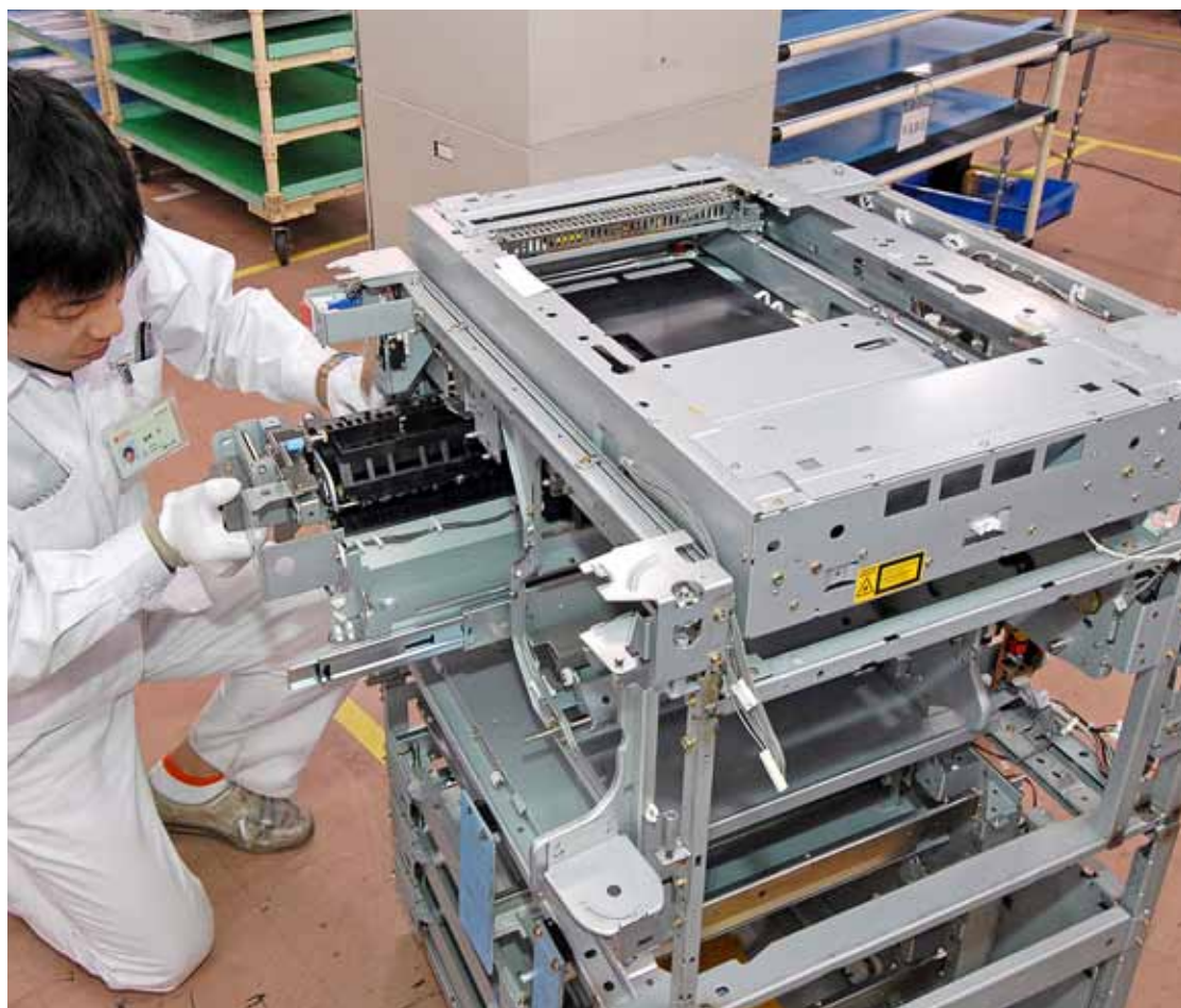
使用済み製品を分解洗浄し、再度組立てられる再生機
