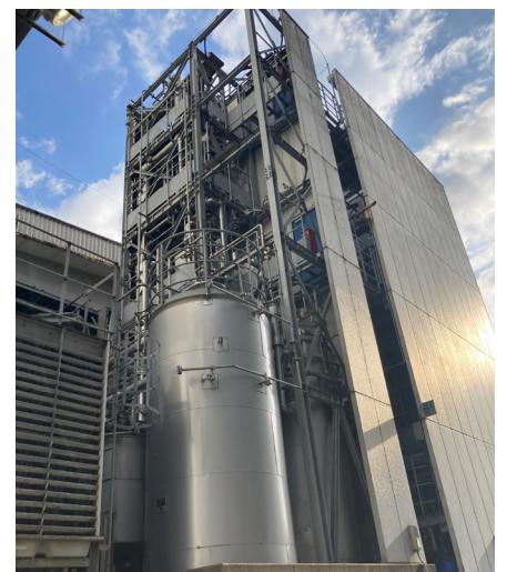
溶剤のクローズドリサイクルが行われている施設(蒸留塔)
