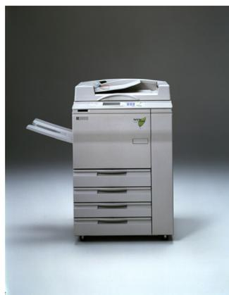
リサイクル対応設計複写機 Spirio 2700。分解にかかる時間を短縮するためのネジ数の削減、プラスチック材料の素材統一、剥がす手間のかからないデカル（シール）の開発など、リサイクルを容易にするための設計が採用されました。
