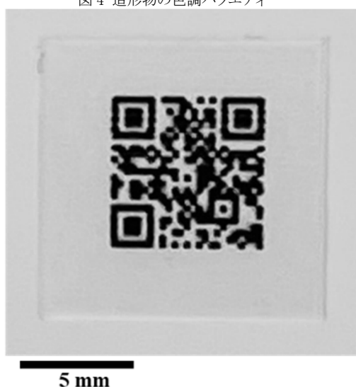
図5 印字の微細性(厚み 1mm のクリア造形物内部にカラーインクで描画) (出典: https://jp.ricoh.com/technology/tech/132_high-strength_full-color_3D_printer )
