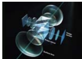
超広角レンズから入射した光は、プリズム・ミラーで反射されて90度曲げられ、撮像素子で受光される。
