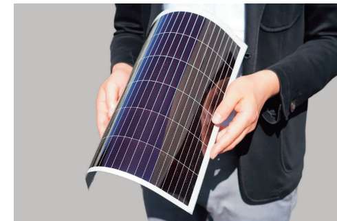
インクジェット印刷ペロブスカイト太陽電池
