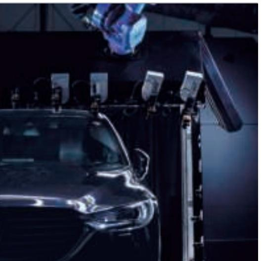
車両塗装外観検査装置
