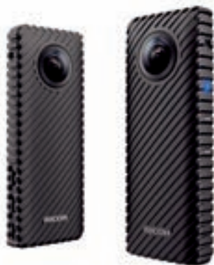
全天球ライブストリーミングを可能にするカメラ [RICOH R Development Kit]
