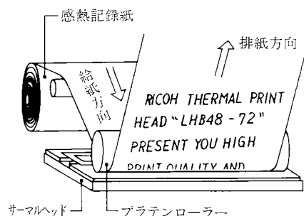
図1 感熱記録方式の基本的構成
