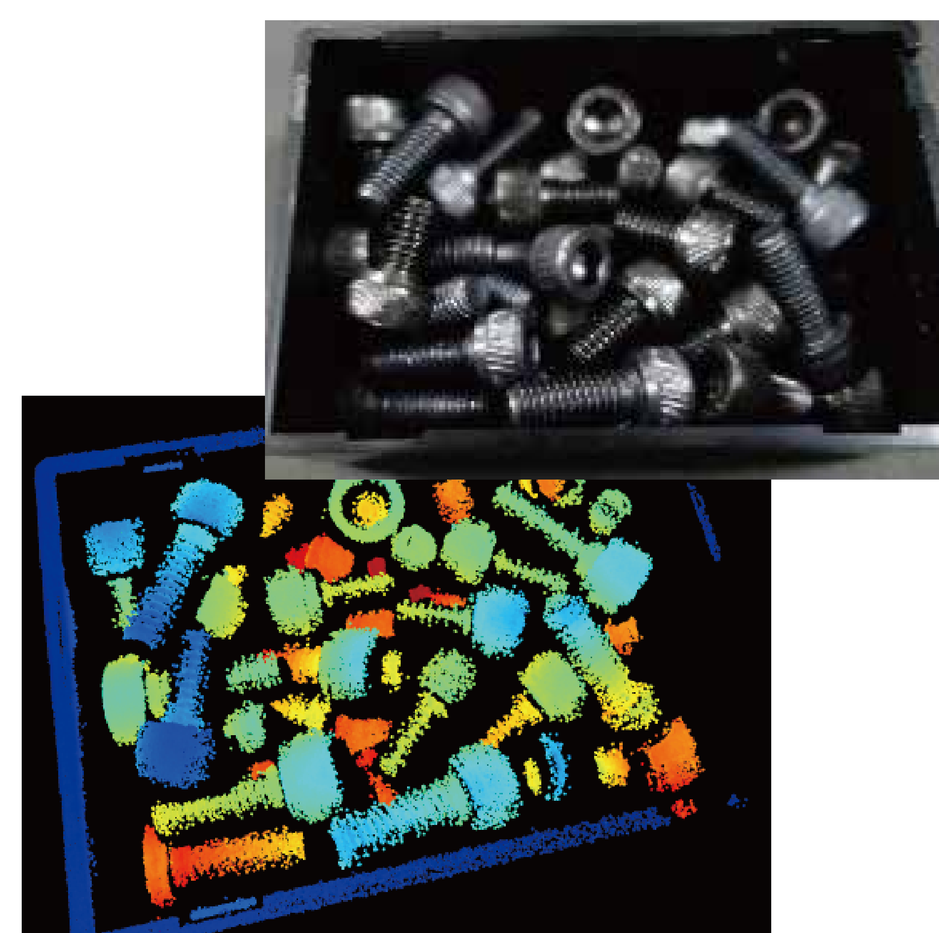
バラ積部品 (ボルト) の計測例
