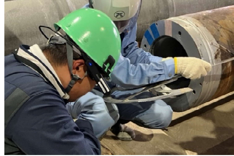
現場作業員が装着したウェアラブルカメラでミリ単位の測定結果を配信している様子
