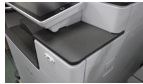
水平リサイクルによる再生プラスチック搭載の外装カバー
