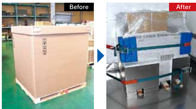
廃棄されるのはラップのみ。ベルト、コーナー養生具、枕木はリユース可能
