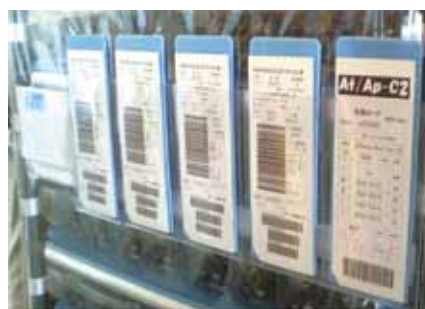
台車に貼り付けられたRECO-View RFタグシート
