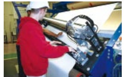
ロールをつなぎ合わせる作業の様子
