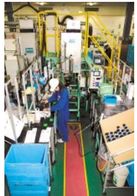
2畳ほどのスペースがあれば、誰でも簡単にトナーの充填再生が可能。
