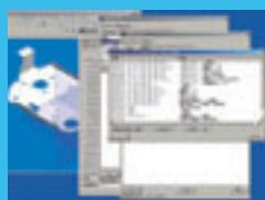
LCA設計を推進するために、環境面・コスト面から最適な材料や部品を選定するシステムです。調達管理システムや化学物質管理システムと、設計のCADシステムが連動しています。
