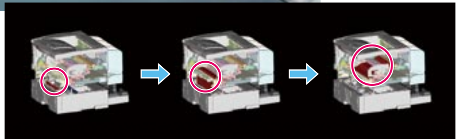
試作機で、狙い通りに紙詰まりを発生させるのは難しいが、バーチャル試作機なら簡単
