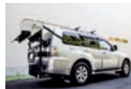
路面性状モニタリングシステムを搭載した車両
