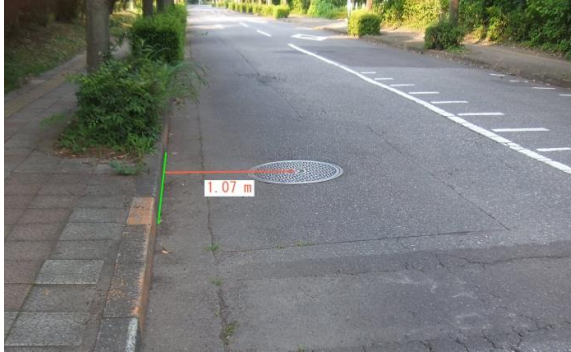
マンホールと道路の距離を測定 (1点と直線の最短距離)
