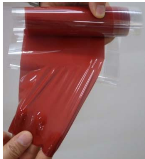
伸縮自在で薄い発電ゴム (色の付いている部分が発電ゴム)
